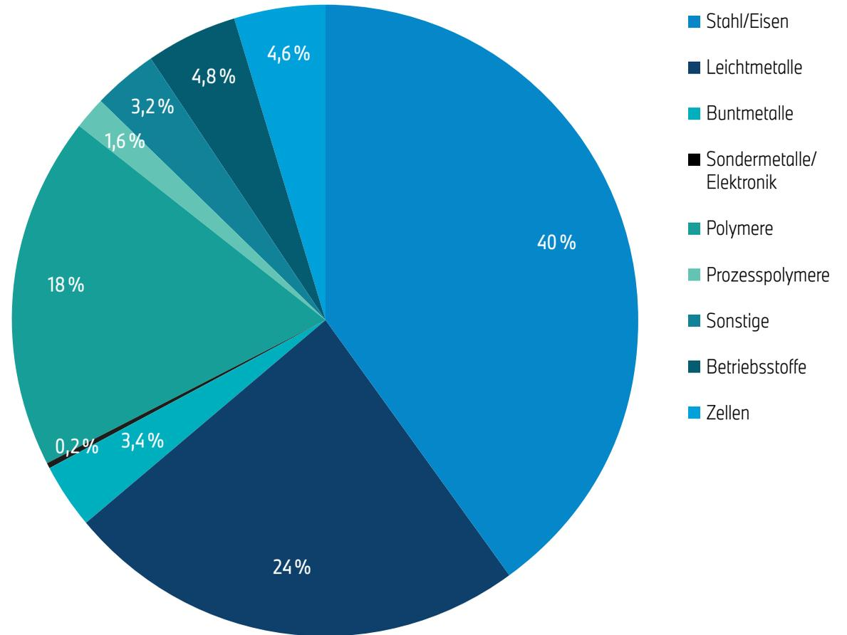
Abb. 2: Werkstoffzusammensetzung des BMW 530e zum Produktionsstart.
